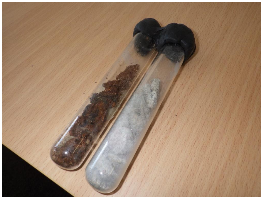
Kuva 9 Kiviainesmateriaalien kosteusmittausta näytepalamenetelmällä
