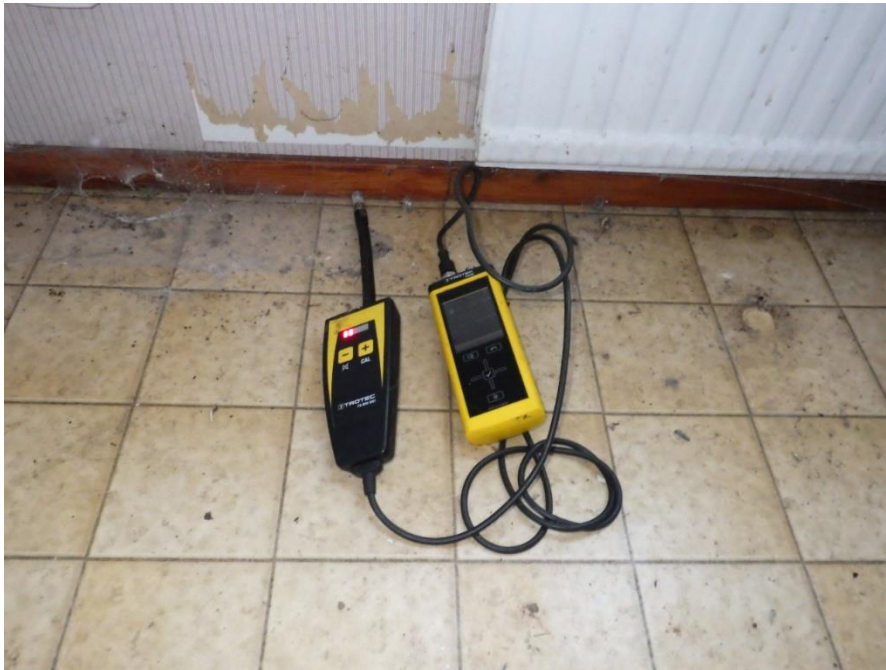
Kuva 18 Merkkiainekokeen suorittamista, kaasun kulkeutumisen tarkastelua sisätilojen puolelta
