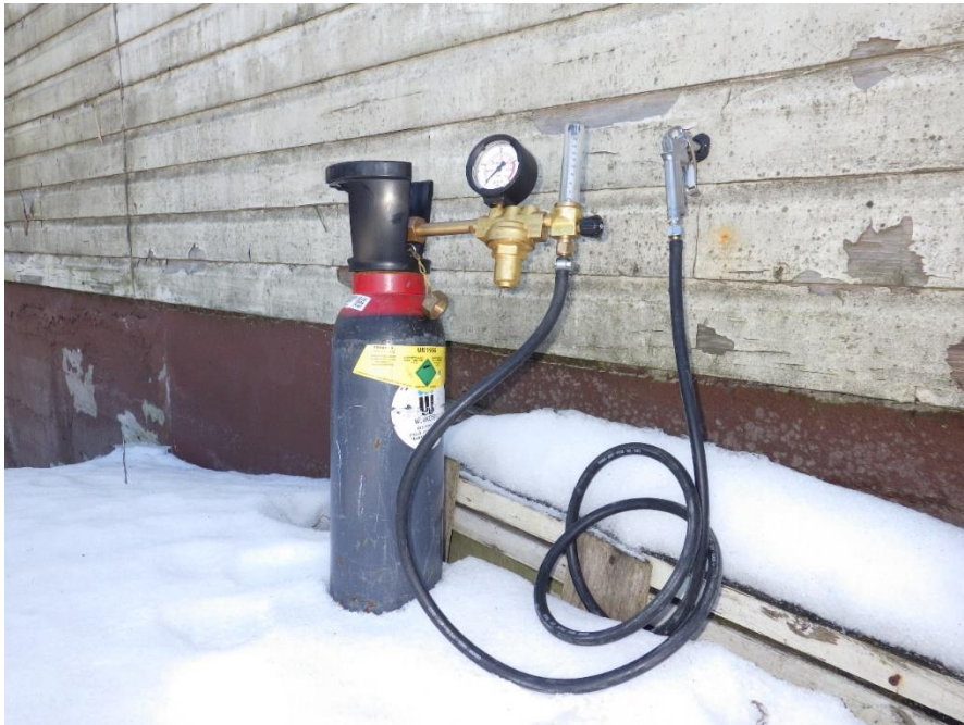
Kuva 17 Merkkiainekokeen suorittamista, kaasun vapauttamista ulkoseinän eristetilaan
